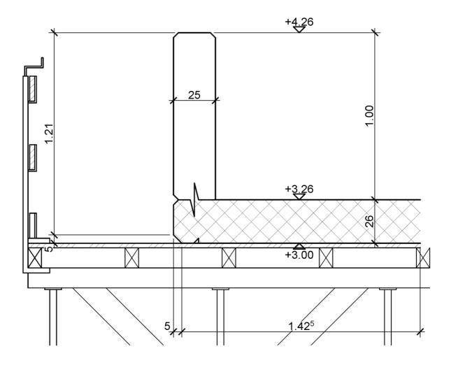
Schematischer Schnitt durch Brüstung
